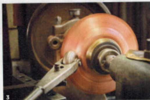
**1. Werkstatt:** Die edle Kupferware entsteht an der alten Drehbank.
